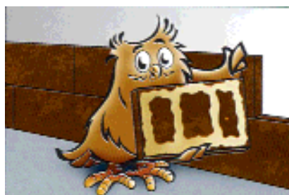
Collage par bandes ou par plot sur les bords ou toute la plaque.
